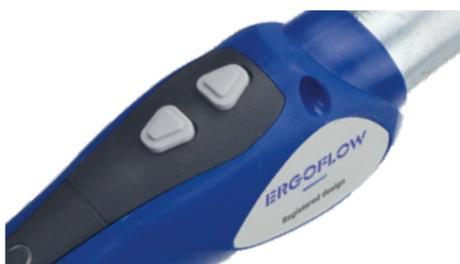
Il est possible d'intégrer plusieurs modules de switch dans le capot de la torche (ex : changement de programme, réglage de courant +/-, ajustement de la hauteur de la potence...). Concernant le câblage : nous consulter.
