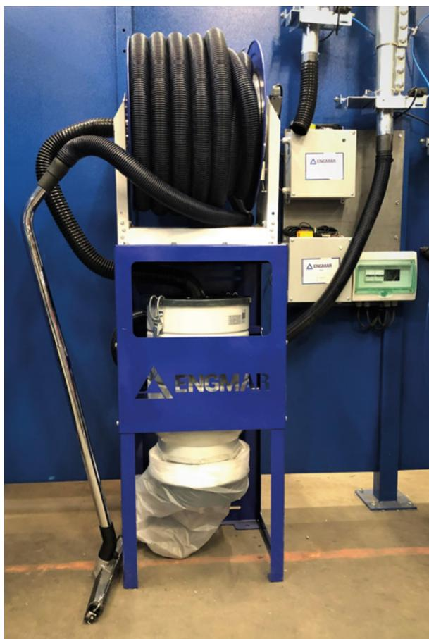
Le cyclone KBCNF est constitué d'un KBCNL sur support fixe et d'un enrouleur. Le cyclone KBCNL assure une décantation des poussières et d'autres déchets aspirés afin d'éviter leur propagation dans les réseaux d'aspiration ou les groupes aspirants. Ces déchets décantent ensuite dans un sac de vidange. L'enrouleur de tuyaux permet de ranger le tuyau d'aspiration du cyclone. Le support se fixe au sol ou contre le mur.
