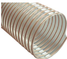
Les flexibles sélectionnés par **ENGMAR** sont fabriqués en polyuréthane avec spire acier cuivrée. Leur conception permet une bonne résistance à la compression et à l'abrasion tout en conservant une bonne souplesse au niveau de leur courbure. D'autres flexibles sont disponibles sur demande, notamment pour les opérations de meulage nécessitant un flexible résistant aux particules incandescentes en grandes quantités.
