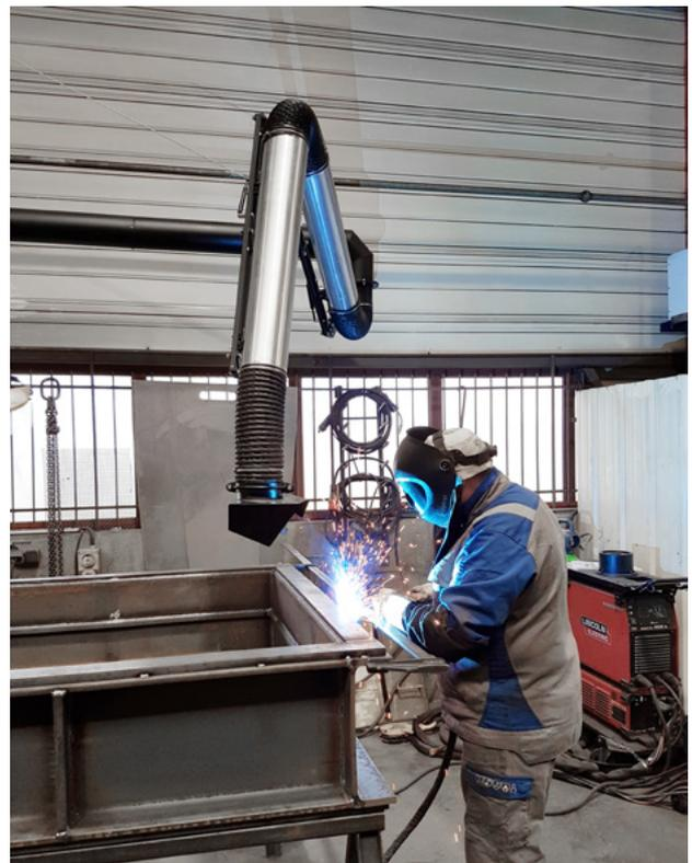
*Bras ARMOWELD et capteur laminaire REVOLFLOW*
