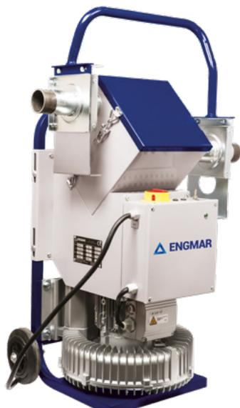
Le BBPASS permet de distribuer l'aspiration entre les 2 piquages des groupes BB double entrée. L'aspiration fonctionne alors selon la position du BBPASS uniquement sur une des deux entrées pendant que l'autre entrée est fermée. Il permet par exemple l'utilisation alternée d'une torche aspirante MIG/MAG **ENGMAR** et d'un capteur laminaire **ENGMAR** sur un même groupe. Ce fonctionnement n'est pas compatible avec les groupes BBTD.
