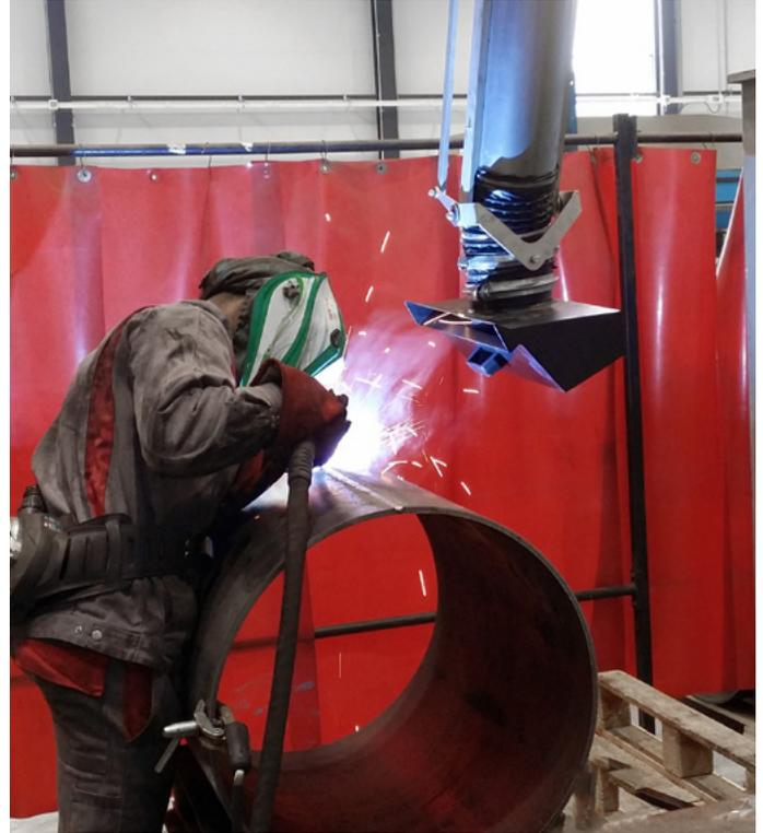
*Bras aspirant ARMOWELD et capteur REVOLFLOW*
